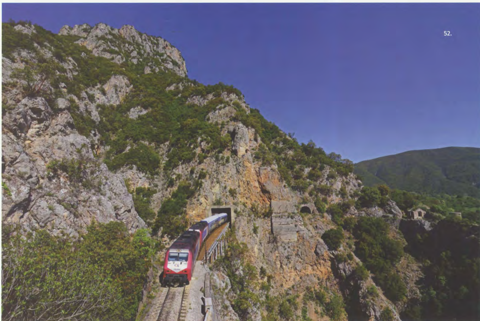
51. & 52. / Αυτή είναι η εικόνα της γέφυρας από την αντίθετη της προηγούμενης φωτογραφίας πλευρά. Σε λίγο, το IC θα χαθεί στα σπλάχνα του Κούβελου. Στα αριστερά, η μακρόστενη αμυντική στοά που κατασκευάστηκε μεταπολεμικά για προστασία της γραμμής από πτώσεις βράχων. (30.4.2006 - Κ. Κακαβάς). Από το στέγαστρο της τραβήχτηκε η δεύτερη φωτογραφία με τις 220 014+ 220 033 να εξασφαλίζουν το δρομολόγιο IC53 (24.4.2017 - Ν. Παπαλέτσος).
