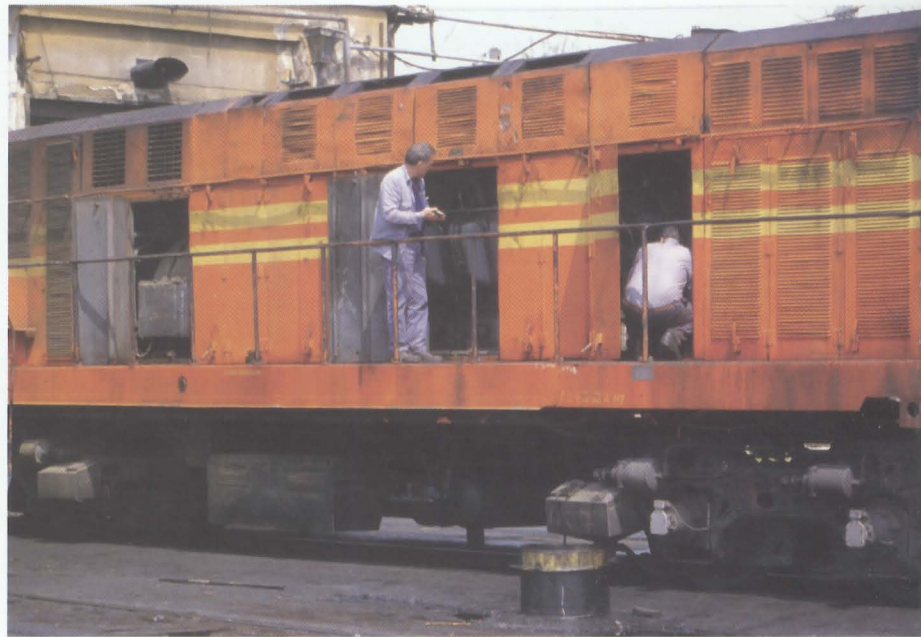
Σ. | Χωρίς τον μόχθο των τεχνιτών του ΜΘ, η κυκλοφορία των μηχανών θα ήταν αδύνατη. Εδώ, αλλαγή φίλτρων στον ισχυρό κινητήρα της MLW A506 ( 10 Δεκ. 1999 - Γ. Χανδρινός).
