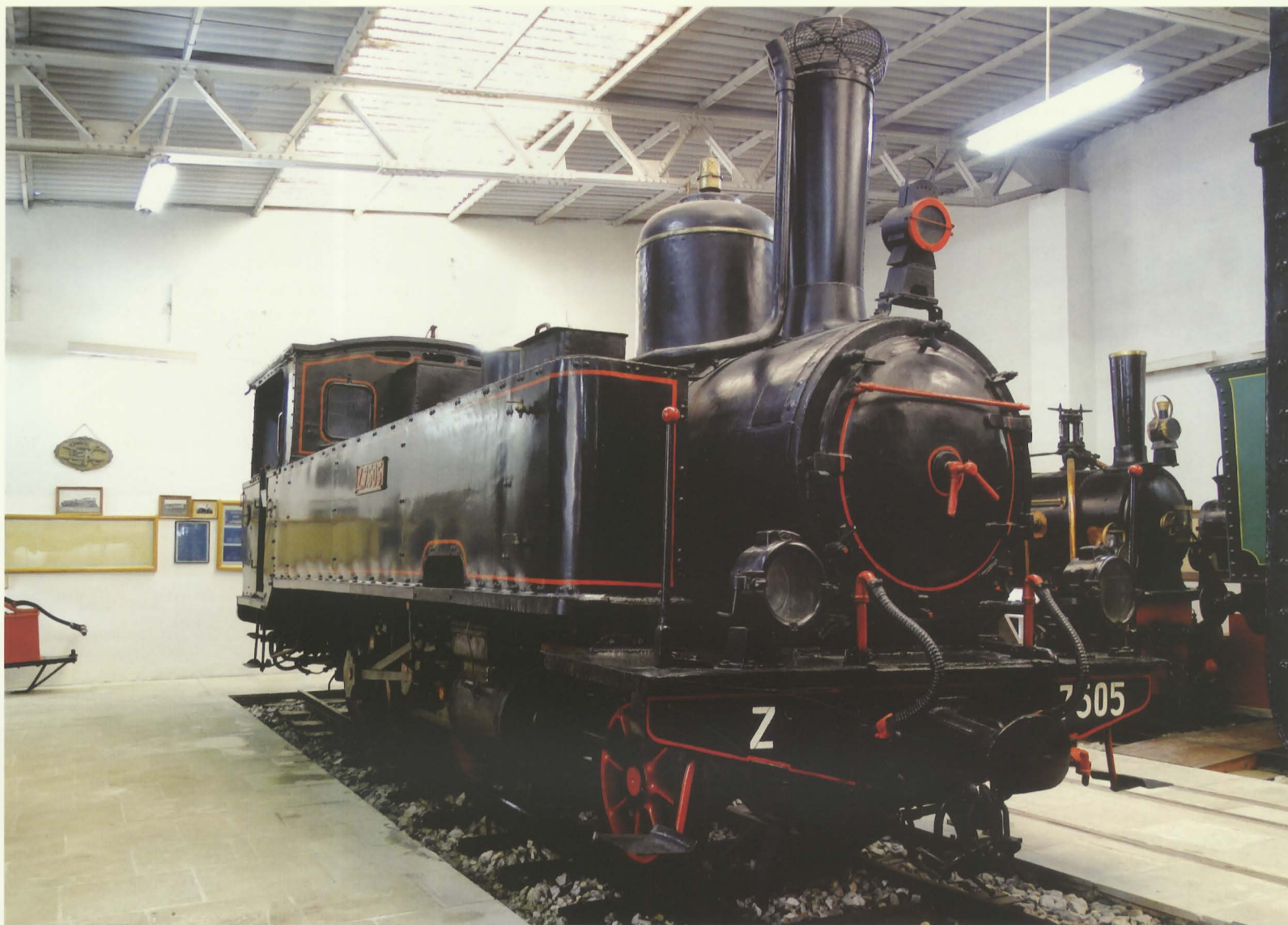
Τριαξονική 2-6-0 Z 7505 "ΕΡΥΜΑΝΘΟΣ" είναι κατασκευή της γαλλικής SACM (1893)
