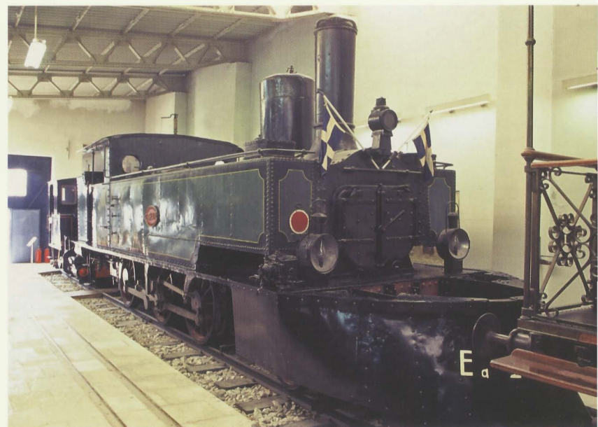
Εα 204 ατμάμαξα 2-6-0, κατασκευής του γαλλικού οίκου Batignolles (1903)
