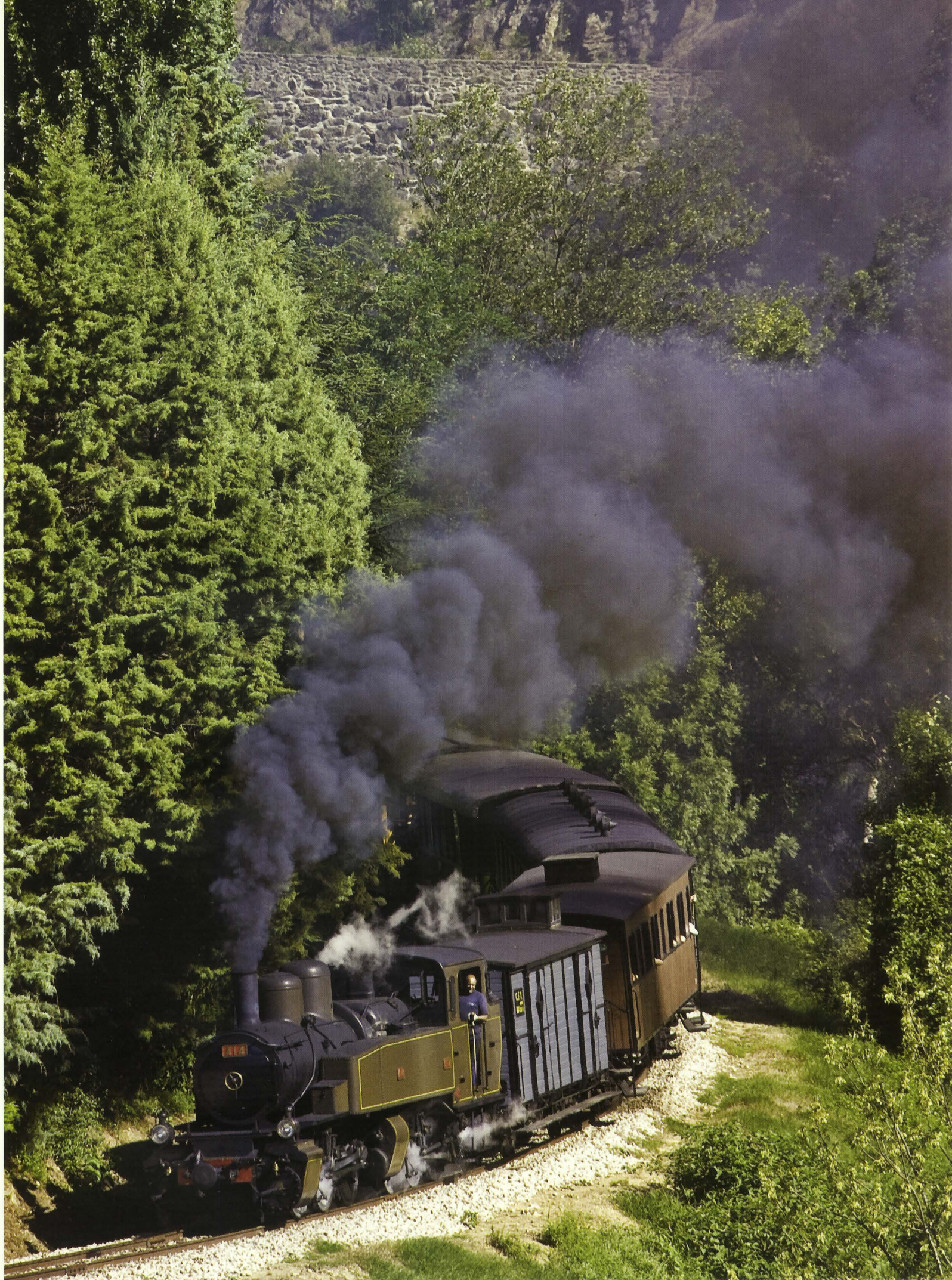
414, στράμαξα Mallet 030+030, 48 τόνων, κατασκευής 1932.
