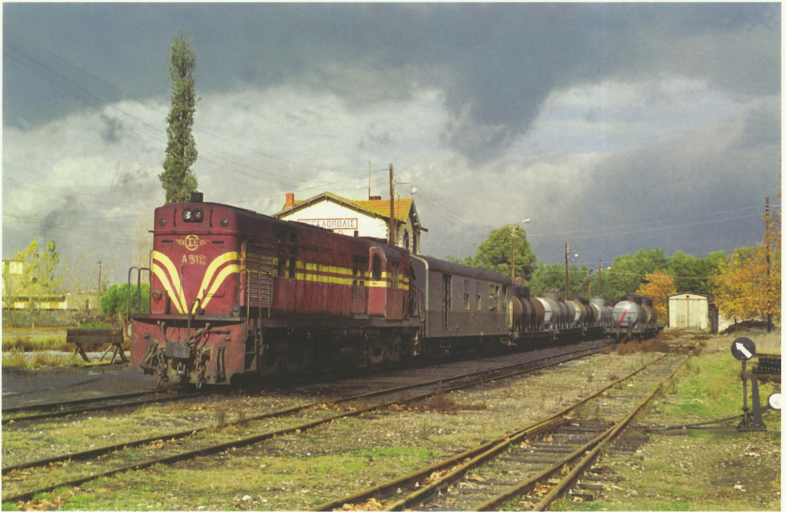
Alco A9112 με την αμαξοστοιχία μεταφοράς καυσίμων ξεφορτώνει το πολύτιμο υγρό στον ΣΣ Μεγαλόπολης.
