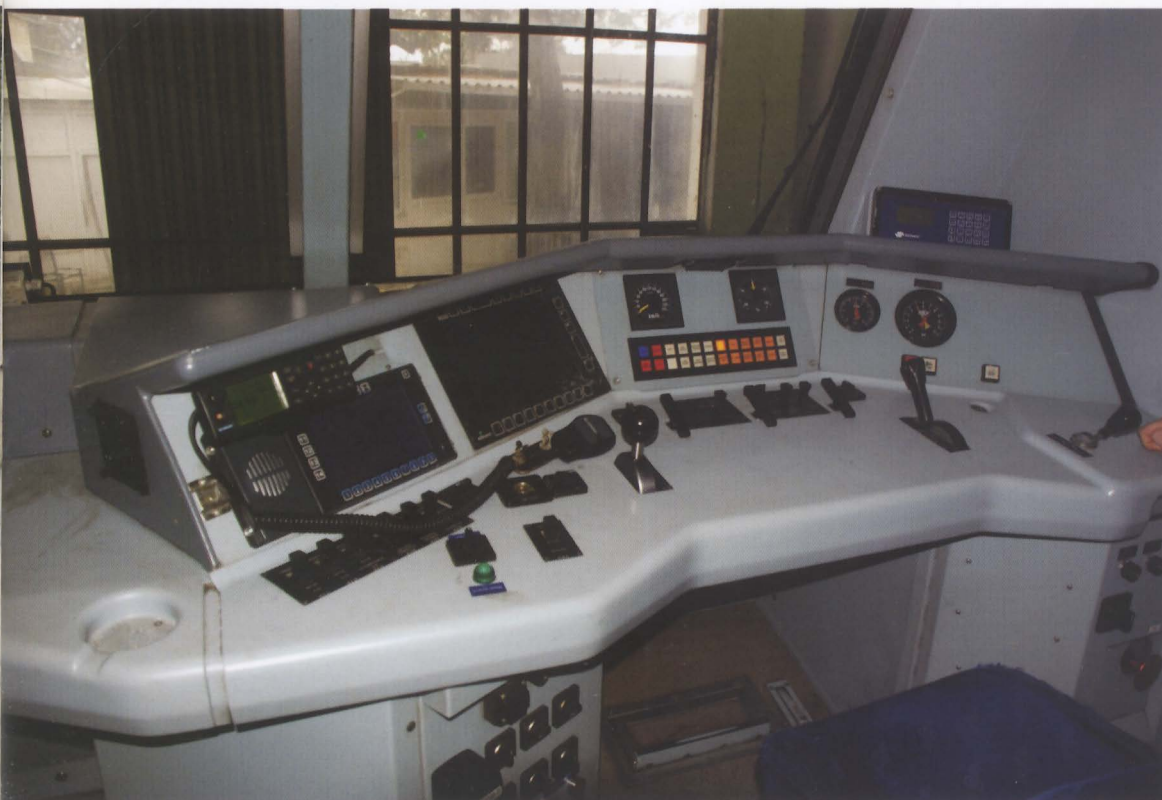
Φαίνεται η διεπαφή μηχανοδηγού (οθόνη χειρισμών) του συστήματος GSM-R. Φωτογραφία Κωνσταντίνος Χρονάκης.
