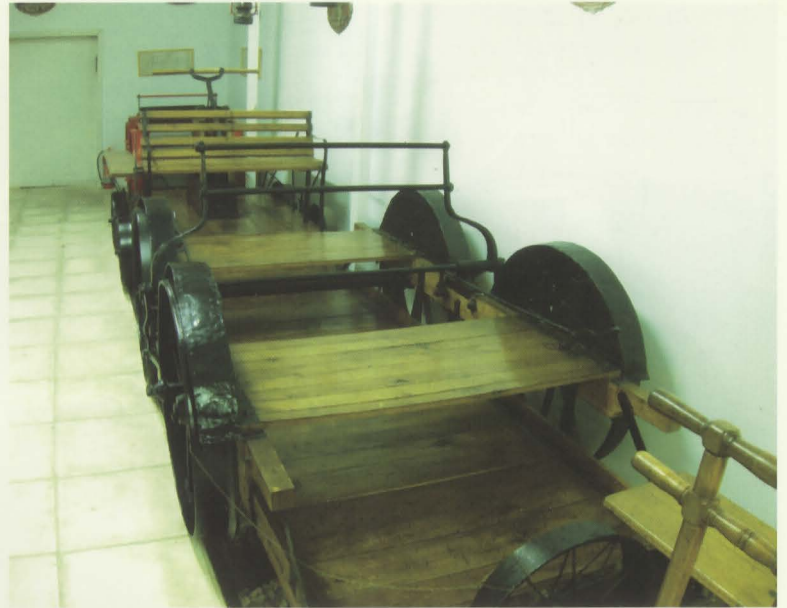
Χειροκίνητες δραιζίνες, μέρος του υπηρεσιακού τροχαίου υλικού των σιδηροδρομικών δικτύων
