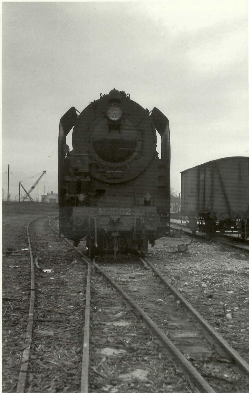
Μια από τις ελάχιστες φωτογραφίες στην Ελλάδα ατμάμαξας Μα, με τους μεγάλους, εργοστασιακούς καπνοδιώκτες:
