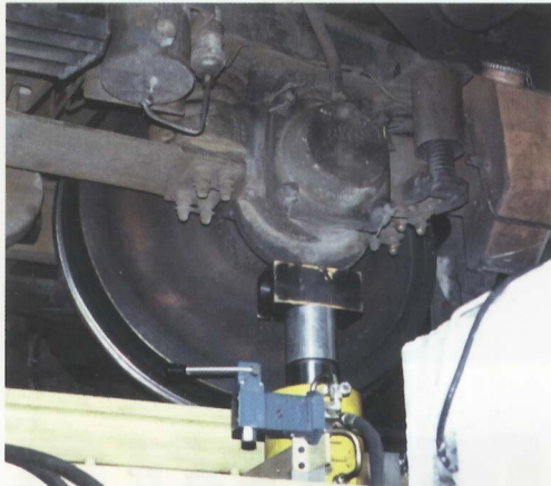
Οι φωτογραφίες παρουσιάζουν το υπερουχρόνο τórνο και τις εγκαταστάσεις του ΟΣΕ, που αυτός λειτουργεί
