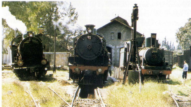
Ιστορική παράταξη στο μηχανοστάσιο της Dera'a. Από αριστερά προς τα δεξιά: Borsig 2-8-0 N.160, Hartmann 2-8-2 N.263 και Jung 2-6-0 N.66
