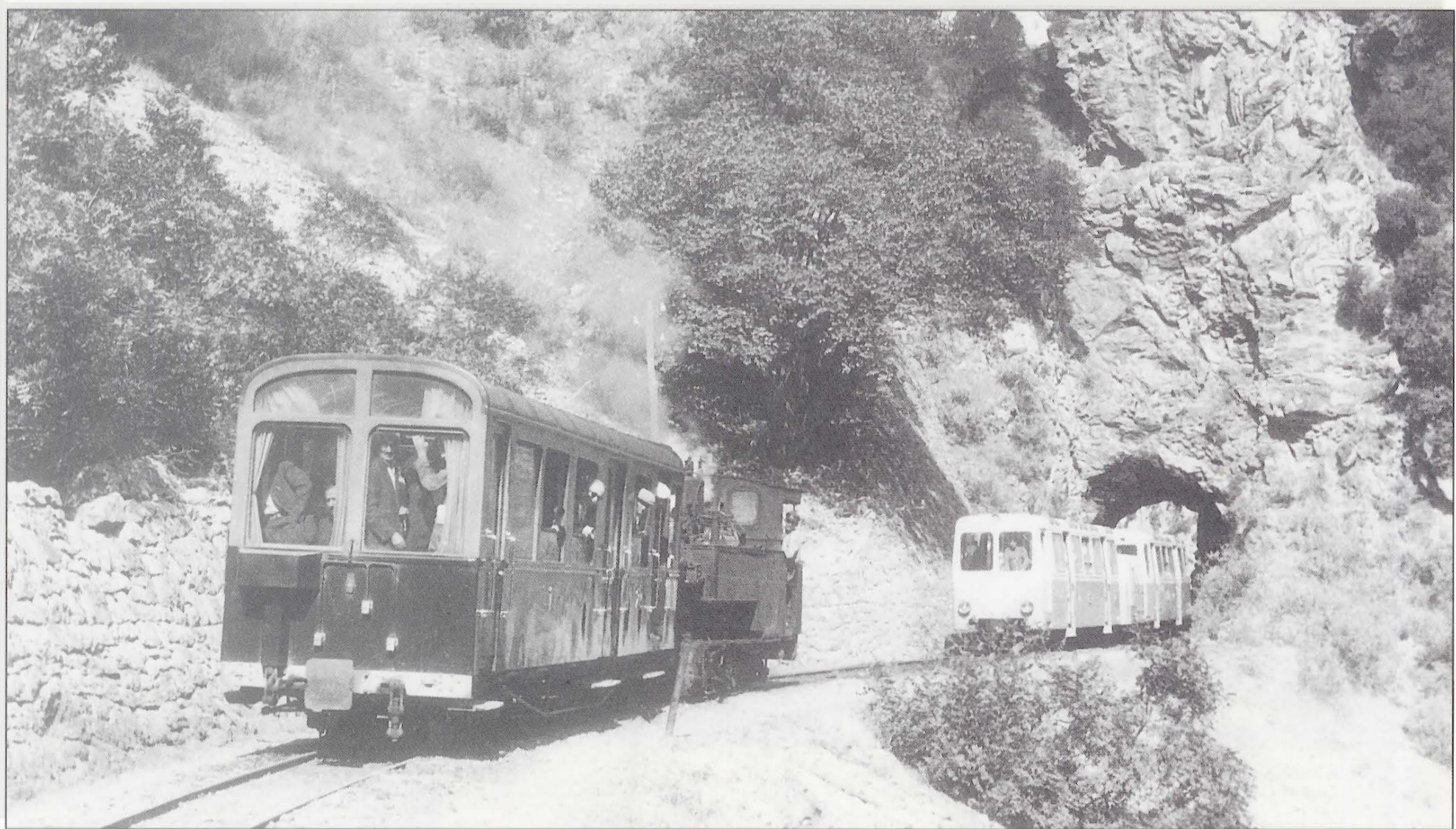
Δεν είναι συνάντηση δύο εποχών αλλά απλή ακολουθία με “πορεία εν όψει” στο χλμ. 8,2 (Ιταλική “μόρτα” διασταυρώσεων). Προπορεύεται ο γηραιότερος ατμηλάτος σιδηρός με την επιβατάμαξα ΔΚ 131 και έπεται η νεότευκτη τότε αυτοκινητάμαξα Billard (1959)
