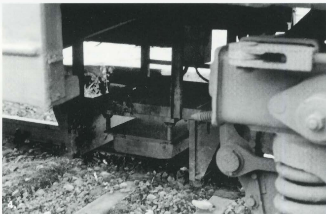
3. Χειριστήρια H/A Skoda. Διακρίνεται η κονσόλα του ETCS. 4. Σε πρώτο πλάνο η αντένα του ETCS τοποθετημένη στο φορείο. Φωτογραφίες 1-4 Γ. Καραθανάσης
