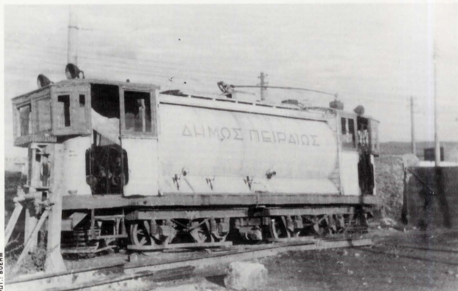
ΕΠΑΝΩ: Μια σπάνια φωτογραφία που δείχνει το τραμ που χρησιμοποιούσε προπολεμικά ο Δήμος Πειραιά σαν «όχημα καταβρεχτήριο» για τους δρόμους. ΑΜΑΞΟΣΤΑΣΙΟ ΤΡΑΜ (ΗΕΜ) Ν. ΦΑΛΗΡΟΥ 1942.
