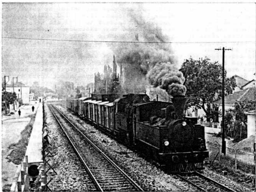
Ατιμάμαξες Σ.θ. N ο 21(2-6-0T, TUBIZE) και N ο 43(2-6-2T, JUNG) επιμεφαλής της πόστας Βόλου-Καλαμπάκας - ΒΟΛΟΣ-ΜΑΗΣ 1967 (Φωτ. ALAN BOWLER)
